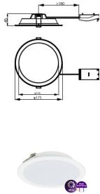
Technische Daten Philips LED Downlight Lediniare DN065B Meta I Weiß 12W 1200lm 110D - 830-840-865 CCT | 175mm - Ausschnitt 150mm - IP20
