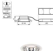
Technische Daten Philips LED Downlight LuxSpace Mini DN560B 7W 840lm 80D - 830 Warmweiß | 164mm - Aluminium Reflektor
